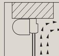
Der vorgebaute ALUKON-Rollladen liegt außerhalb des Fensters und vermeidet so Wärmeverluste.
